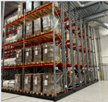
Mobile pallereoler – en holdbar løsning, der næsten fordobler din lagerkapacitet.
