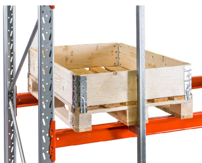
Pallestop vertikalt – monteres i bagkant på pallereol og forhindrer at pallen sættes for langt ind.
