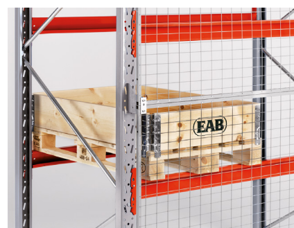
Rygnet – kraftig netramme monteres på bagkant af pallereol og forhindrer at godset falder bagud af reolen.
