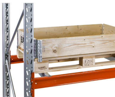
Langsideindlæg – skrues på bærebjælkerne. Bruges altid ved langsidehåndtering af pallerne.
