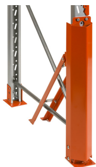
Stolpeforstærkning 90 høj model – for montage på studsodplade. Giver den absolut bedste beskyttelse af den mest udsatte del af stolpen. Højde 760 mm.
