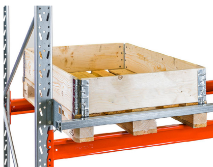
Pallestop horisontalt – monteres i bagkant på pallereol og forhindrer at pallen sættes for langt ind.
