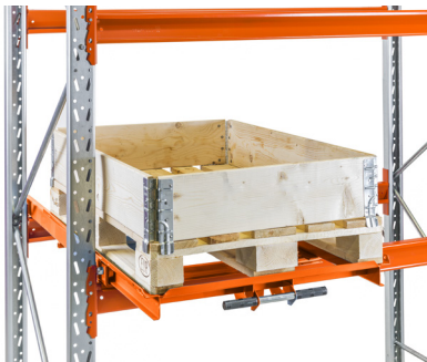
Udtræksenhed – for plukgods med eller uden palle. Giver bedste ergonomi ved plukning. Monteres på bærebjælkerne. Maks. belastning 700 kg.
